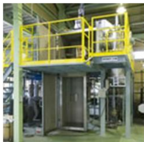
真空鋳造設備
