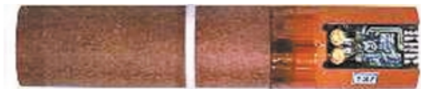
金沢工業大学先端電子技術応用研究所で開発した低温超伝導SQUID
