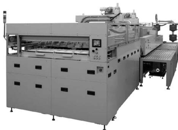
太陽電池反射防止膜製造用プラズマCVD装置 SLPC-TB
