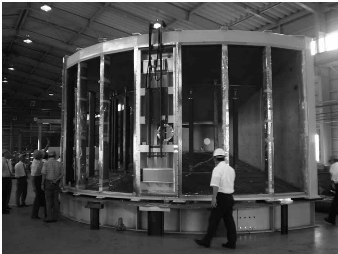
J-PARC物質生命科学実験施設BL14アマテラス 約30トンの真空槽
