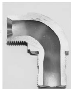
開発製品(NNT継手) ドリル加工なし、バリが出ない
